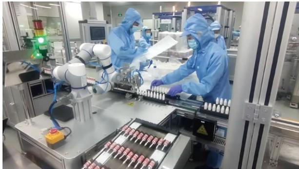
在一家化妝品工廠，睫毛膏生產線的工作人員將睫毛膏管及刷子放置於傳送帶上進行液體填充，其後由我們的協作機器人裝配刷子及膏管。
