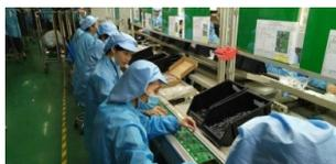
根據PCBA的設計，PCB可能包括若干其他不能通過SMT放置於PCB上的電子元件。在該情況下，PCB將通過DIP進行進一步處理，從而將該等元件的引線彎曲並通過PCB上的指定孔手動插入PCB。
