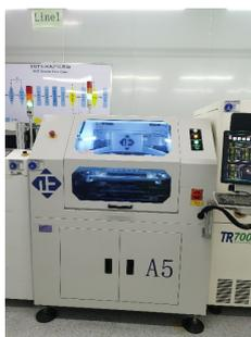
使用錫膏模板印刷機將錫膏印置於PCB上。SPI和／或目視檢測可確保PCB指定區域所用錫膏的使用量及厚度是否正確，且在PCB上安裝IC及元件時有足夠的錫膏以進行焊接。
