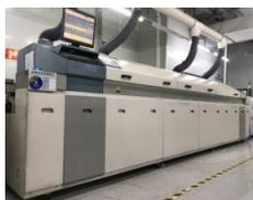
在將元件安裝到PCB上後，PCB經由輸送帶傳送，通過回流焊爐焊接元件。在回流焊爐中，應用在PCB上的焊膏被加熱和熔化，以保持IC處於恰當位置。將熔化的焊膏冷卻，以保持IC附著在PCB上。這一步是將電子元件固化並粘附到PCB上。
