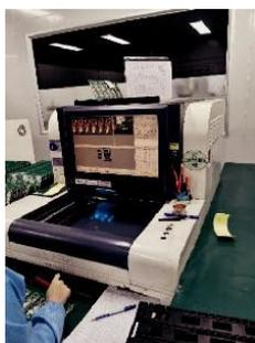
AOI，即攝像機自動掃描被檢測的PCB是否缺失元件和存在品質缺陷（例如尺寸或形狀偏差），及／或進行視覺檢測，以確保焊膏和安裝元件已分別正確地應用和放置到PCB的恰當區域。
