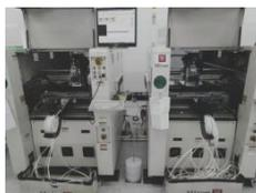
自動貼片機中的貼片機通過真空貼裝頭吸取元件，包括晶片、IC和連接器，並貼裝到PCB上。
