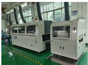
插入元件後，PCB被浸入熔融焊料槽機中，泵產生熔融焊料的上升波。當PCB與熔化的焊料波接觸時，元件被焊接到PCB上以產生PCBA。
